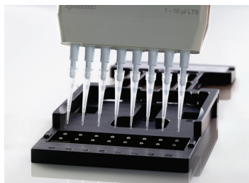
그림 2. 2μL의 다수의 시료에서 핵산 및 단백질 정량을 위해 Agilent BioTek Epoch 2 마이크로플레이트 분광 광도계와 함께 Agilent BioTek Take3 마이크로볼륨 플레이트를 사용합니다.
